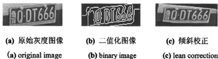
图 3-1 有明显边框的倾角检测与修正结果
