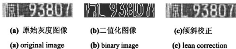
图 3-2 无明显边框的倾角检测与修正结果
