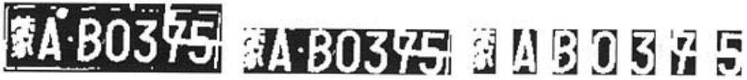
字符粘连的车牌图像 预处理后字符粘连的车牌图像 / 分割后的图像
