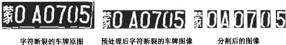
图 3.1 断裂车牌的分割
